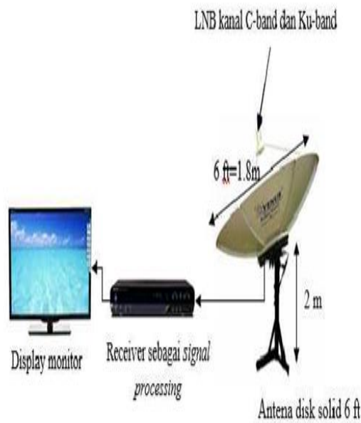
Gambar 9. Perancangan sistem pengukuran sinyal komunikasi satelit
