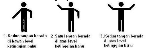
Gambar 2.2 Klasifikasi sikap kerja bagian lengan
