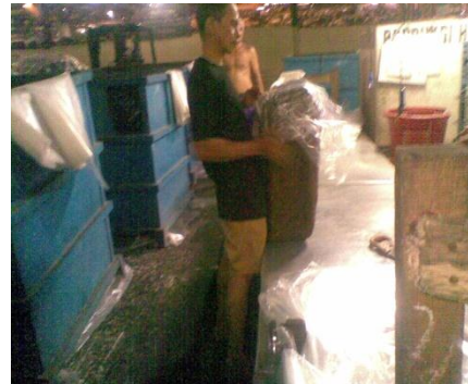
Gambar 1.1 Operator membungkus bandela karet
