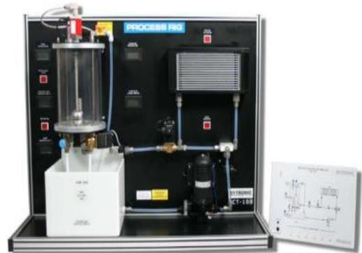
Gambar. 1 Modul Rangkaian PCT-100[1][2]
