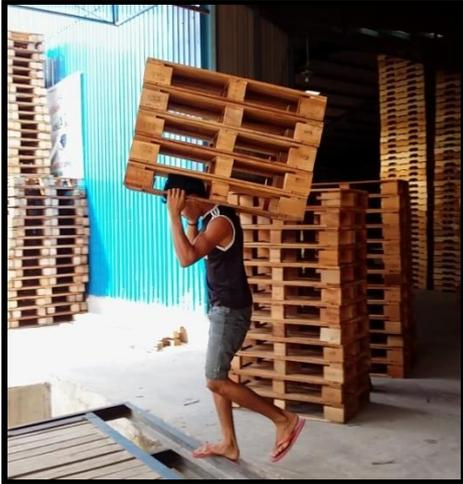
Gambar 1. Pemindahan Pallet Secara Manual dengan Pembebanan Di Bahu
