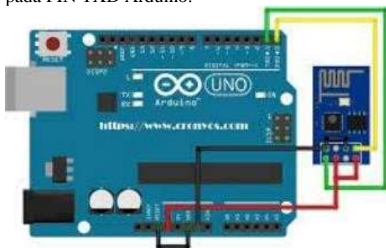
Gambar 7. Rangkaian pembacaan ESP8266
