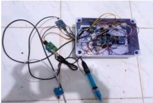
Gambar 6a. Rangkaian prototype pengendali kualitas air
