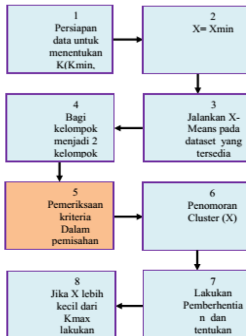
Gambar 1. Langkah-Langkah Umum dalam Pengelompokan X-Means
