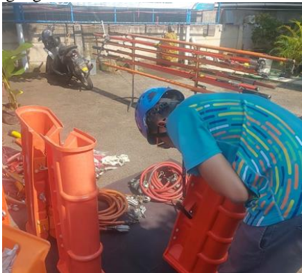
Gambar 2. Peralatan Pelindung Listrik Tegangan Menengah 20kV
