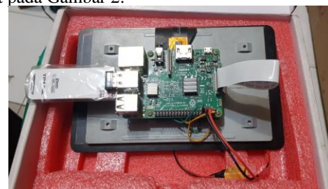
Gambar 2. Tampak Belakang Raspberry Pi 3 Pada Ground
