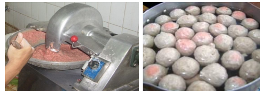
Gambar 1. Penggilingan daging dan perebusan daging dalam pembuatan baso
