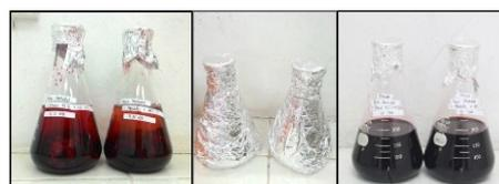
**Gambar 2.** Proses Maserasi: (a) Zat warna buah senduduk mulai terekstrak, (b) Proses maserasi dilakukan dengan cara tertutup selama 24 jam, (c) Hasil ekstrak buah senduduk setelah disaring
