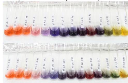
**Gambar 3.** Perubahan dan gradasi warna pada setiap larutan pH *buffer* 1,42-13,47 dengan pelarut aquades-HCl (a) dan pelarut etanol 96%-HCl (b)
