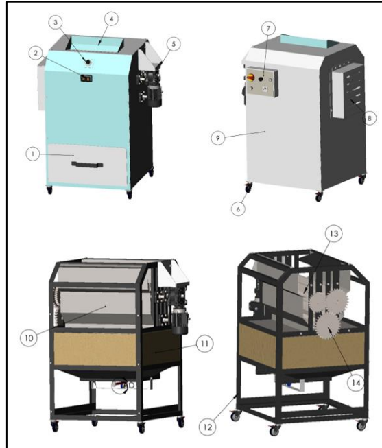
Gambar 7. Desain-Desain Produk Tempat Pengolahan Sampah Masker Medis Beserta Komponen Penyusun
