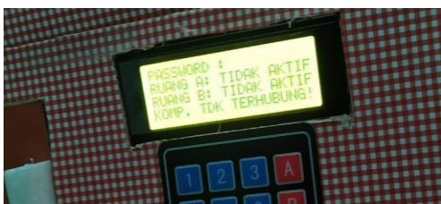
Gambar 9. Tampilan LCD ketika sistem tidak terhubung dan sensor tidak aktif.
