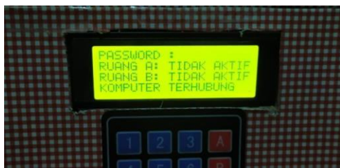
Gambar 10. Tampilan LCD ketika sistem terhubung dan sensor tidak aktif.
