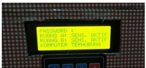
Gambar 11. Tampilan LCD ketika sistem terhubung dan sensor aktif.
