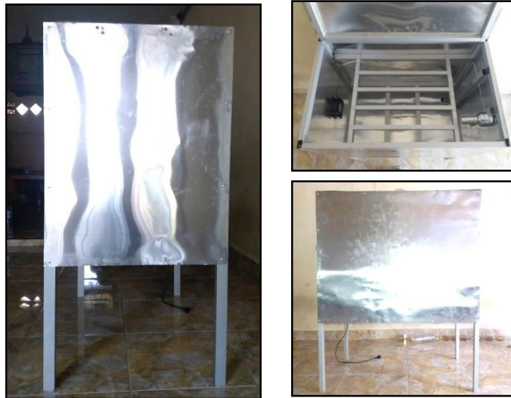
Gambar 8. Alat Pengering Sablon Hasil Rancangan
