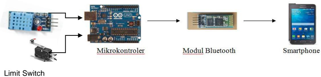
Gambar 6. Perangkat yang digunakan sistem
