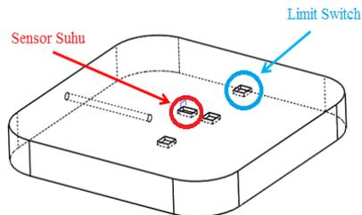
Gambar 2. Rancangan posisi sensor dan limit switch
