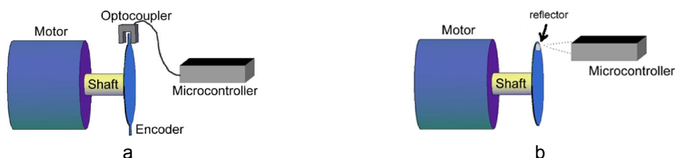
Gambar 1.a Deteksi obstacle menggunakan encoder 1.b Deteksi obstacle menggunakan reflector
