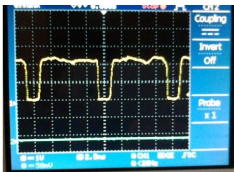
Gambar 4. Pengukuran pada motor 1 \phi pada 3000 rpm, 2 reflector
