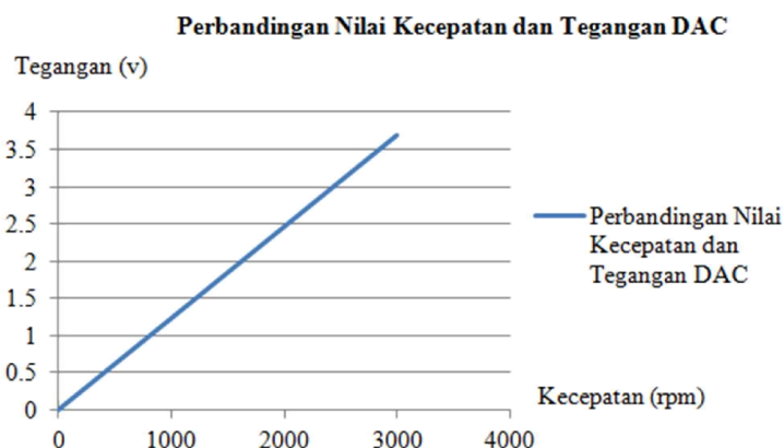
Gambar 8. Kurva karakteristik tegangan output analog terhadap rpm
