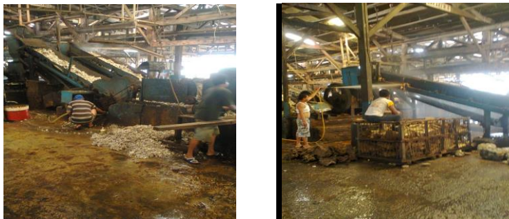
Gambar 1. Kondisi para pekerja yang tidak menggunakan alat pelindung diri pada saat bekerja
