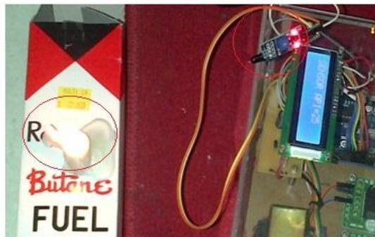
Gambar 6. Pengujian Sensor Api Pada Jarak 7cm Dari Sumber Api
