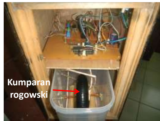
Gambar 7. Rangkaian transduser yang terakit dalam kotak
