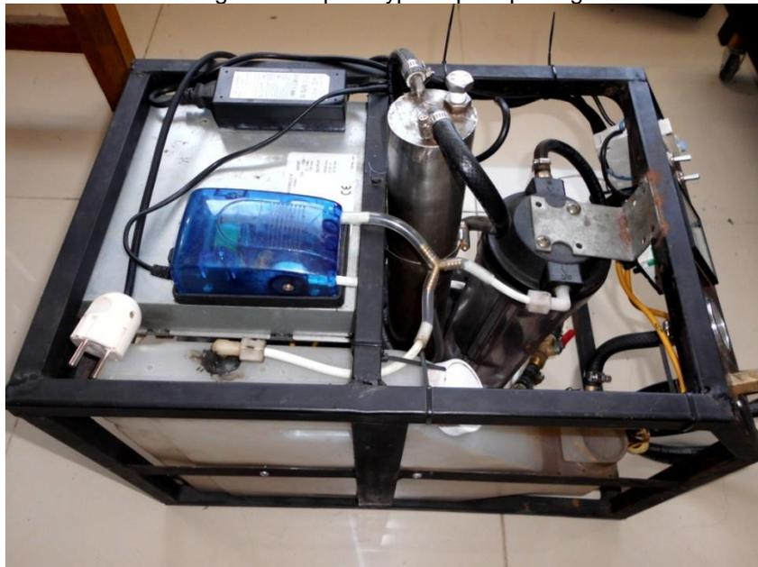
Gambar 2. Prototype Miniatur kompor gas bahan bakar air
