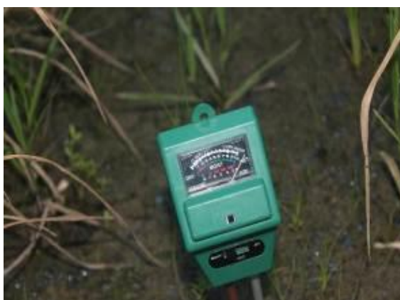
Gambar 8. Pengukuran kelembaban tanah
