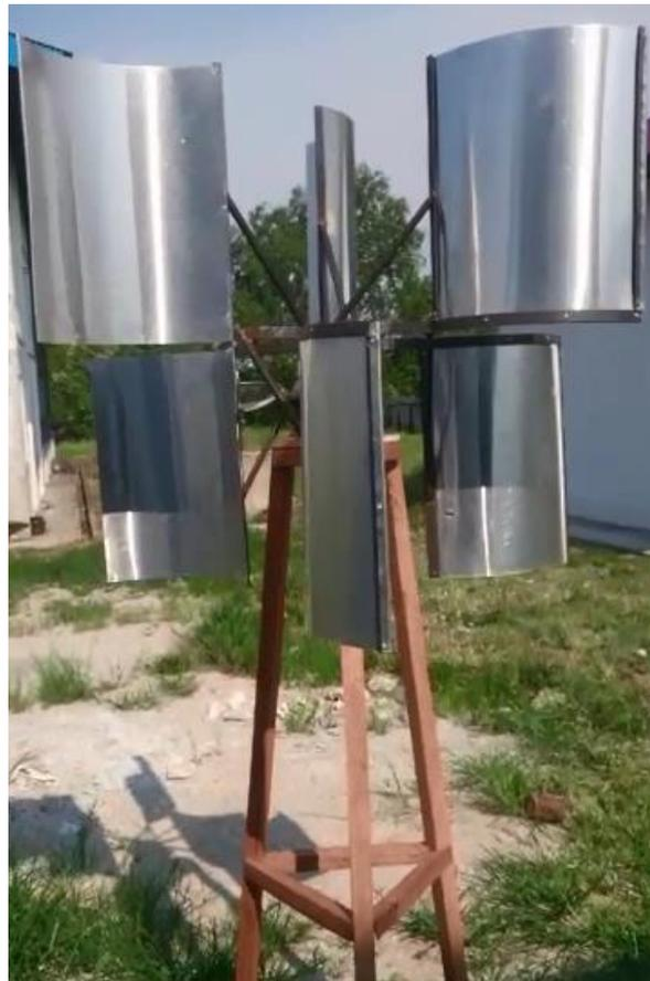
Gambar 3. Hasil perancangan *Vertical Wind Axis Turbin* (VWAT)
