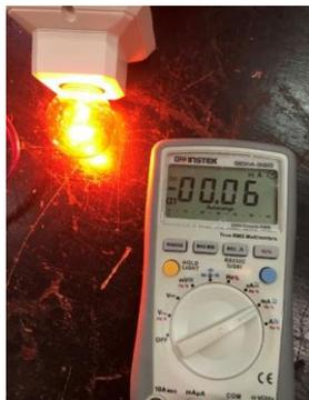
Gambar 8. Pengukuran Arus menggunakan Multimeter
