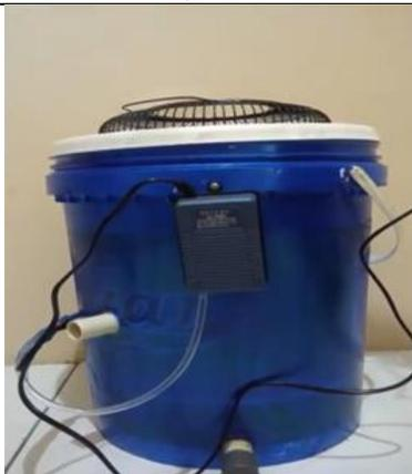
**Gambar 3. Alat Penetralisir Asap yang dikembangkan**
