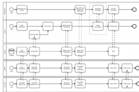
Gambar 4. Rancangan sistem usulan perbaikan
